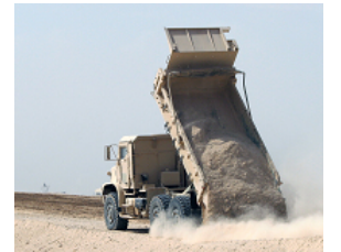
شكل 3.9: عملية تفريغ القلاب مثال عملي على العزم. [6]
